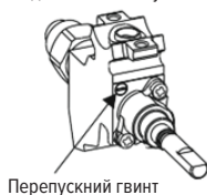
Клапан з пристроєм відключення полум'я
