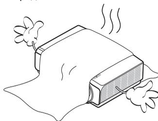
Затруднение вентиляции проектора через отверстия может привести к его перегреву и возгоранию.
