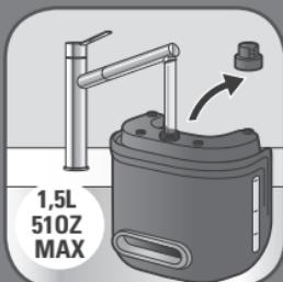
**EE** Eemaldage seade toiteallikast ja seejärel eemaldage veepaak.
