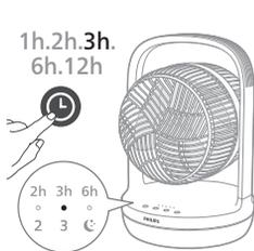
Lai izvēlētos ventilatoru ieslēgt vai izslēgt pēc 1, 2, 3, 6 vai 12 stundām, atkārtoti nospiediet pogu ⌚. Kad taimera atskaite beidzas, ventilators automātiski izslēgsies vai sāks darboties.
