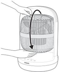
Lama ventilatorului este poziționată inițial cu fața în sus. Înainte de a-l utiliza pentru prima dată, reglează ventilatorul la un unghi adecvat, cum ar fi orientat frontal.
