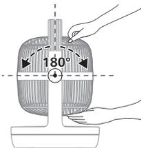
U kunt de ventilator handmatig tot 180 graden verticaal laten oscilleren.
