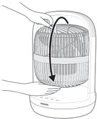
La pale du ventilateur est initialement orientée vers le haut. Avant de l'utiliser pour la première fois, orientez le ventilateur correctement, par exemple vers l'avant.
