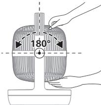
Možete ručno da podesite ventilator da oscilira do 180 stepeni vertikalno.
