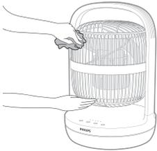
Pulire regolarmente l'esterno del ventilatore per prevenire l'accumulo di polvere.
