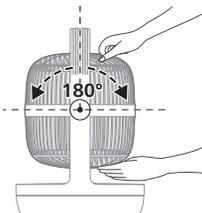
Du kan manuelt justere ventilatoren, så den kan svinge op til 180 grader lodret.
