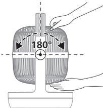
A ventilátort manuálisan beállíthatja úgy, hogy akár 180 fokban függőleges irányban rezegjen.
