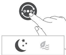
**Loomuliku tuuleiili režiim (🍃):** Reguleerib ventilaatori kiirust üles-alla, et jäljendada öhu loomulikku liikumist ja tuua ruumi värskendav välituule tunne.
