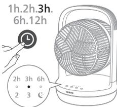
Uzastopno pritisakajte dugme ⌚ da biste odabrali 1, 2, 3, 6 ili 12 sati, kada je ventilator uključen ili isključen. Kada se tajmer završi, ventilator će se automatski zaustaviti ili pokrenuti.
