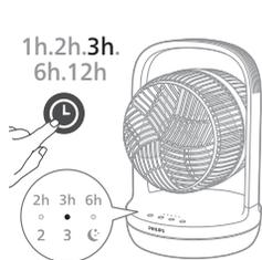
Vajutage ⌚ nuppu korduvalt, et valida 1, 2, 3, 6 või 12 tunni vahel, kui ventilaator on sisse või välja lülitatud. Kui taimer lõpeb, jääb ventilaator seisma või hakkab automaatselt tööle.
