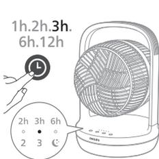
Opakovaným stláčaním tlačidla ⌚ si môžete vybrať z možností 1, 2, 3, 6 alebo 12 hodín, kedy je ventilátor zapnutý alebo vypnutý. Po uplynutí časovača sa ventilátor buď automaticky zastaví, alebo spustí.
