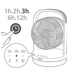
Druk herhaaldelijk op de knop ⌚ om te kiezen tussen 1, 2, 3, 6 of 12 uur, wanneer de ventilator aan of uit staat. Wanneer de timer is verstreken, stopt of start de tafelventilator automatisch met werken.
