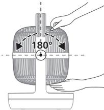
Poți regla manual ventilatorul astfel încât să oscileze până la 180 de grade pe verticală.
