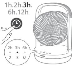
Apasă butonul ⌚ în mod repetat pentru a alege între 1, 2, 3, 6 sau 12 ore când ventilatorul este pornit sau oprit. Când cronometrul se oprește, ventilatorul fie se oprește, fie începe să funcționeze automat.
