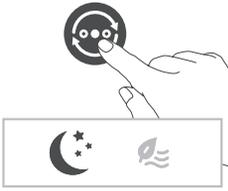
**Modul Nocturn (☾):** Bucură-te de răcoare și liniște în timpul somnului cu modul Nocturn. Acest mod reduce treptat turația ventilatorului la cea mai mică setare timp de 30 de minute, ajutându-te să adormi în mod natural și economisind, în același timp, energie.
