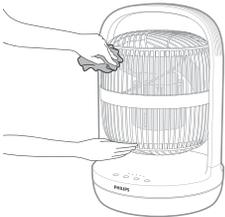
Reinigen Sie die Außenseite des Ventilators regelmäßig, damit sich kein Staub ansammelt.
