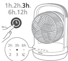
Pritišćite gumb ⌚ kako biste odabrali 1, 2, 3, 6 ili 12 sati, dok je ventilator uključen ili isključen. Kad mjerač vremena završi, ventilator će prestati ili početi raditi automatski.
