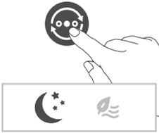
**Mode Brise naturelle (🍃)** : Augmente et réduit la vitesse du ventilateur pour imiter le mouvement naturel de l'air et apporter la sensation rafraîchissante d'une brise extérieure dans la pièce.
