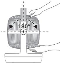
Rankiniu būdu galite reguliuoti ventiliatoriaus pasvirimą iki 180 laipsnių kampu vertikaliai.
