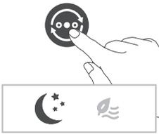
**Sleep-tilstand (☾):** Få en kølig og rolig søvn med den støjsvage sleep-tilstand. Denne tilstand reducerer gradvist ventilatorhastigheden til den laveste indstilling i løbet af 30 minutter, så du kan falde i søvn naturligt, samtidig med at du sparer energi.
