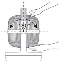
Du kan justera fläkten manuellt så att den svänger upp till 180 grader vertikalt.
