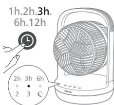
Opakovaným stiskáním tlačítka ⌚ vyberete mezi časem 1, 2, 3, 6 nebo 12 hodin, po kterých se má ventilátor vypnout či zapnout. Po uplynutí časovače se ventilátor automaticky vypne nebo spustí.
