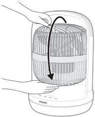
Fläktbladet är till en början vänt uppåt. Innan du använder fläkten för första gången ska du justera fläkten till lämplig vinkel, till exempel vänd framåt.
