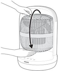
La pala del ventilatore è inizialmente rivolta verso l'alto. Prima di utilizzarlo per la prima volta, regolare il ventilatore a un'angolazione appropriata, ad esempio rivolto frontalmente.
