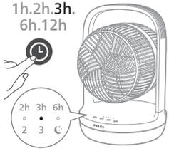
Fan açık veya kapalıyken 1, 2, 3, 6 veya 12 saat arasında seçim yapmak için ⌚ düğmesine arka arkaya basın. Zamanlayıcı sona erdiğinde fan otomatik olarak durur veya çalışmaya başlar.
