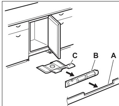
2. Очистите вентиляционную решетку. (См. раздел «Очистка вентиляционного фильтра».)
