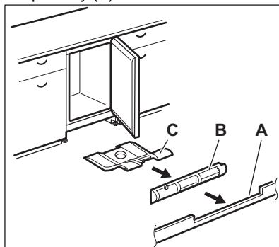
2. Очищте вентиляційну решітку. (Див. розділ «Очищення вентиляційного фільтра».)
