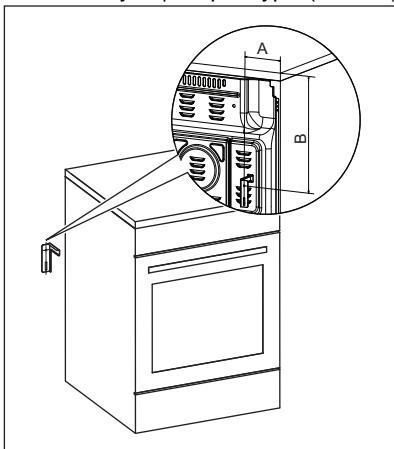
2. На задней стороне прибора находится отверстие с левой стороны. Поднимите переднюю часть прибора и поместите его в центр пространства между
