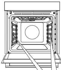
**A** Приподнимите направляющие снизу и отведите от стенки духовки.
